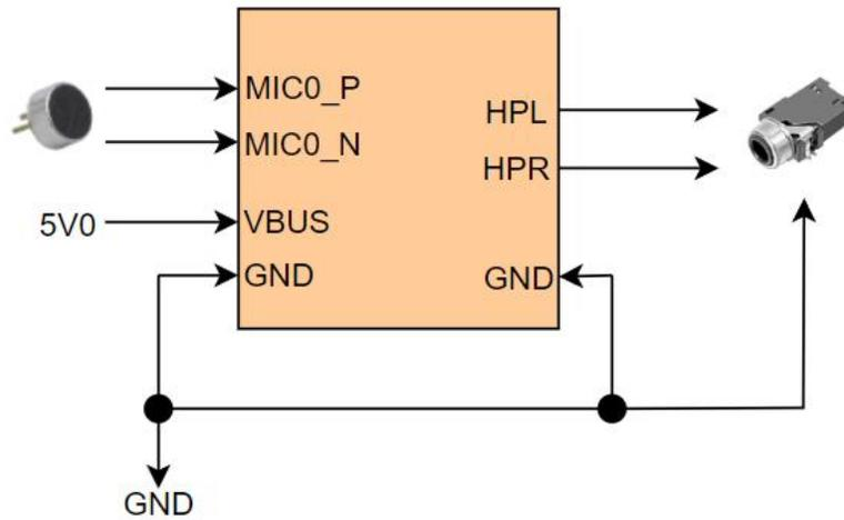
MIC0\_N 和 MIC0\_P 分别接驻极体表的 N 和 P，模块降噪后会将声音通过 HPL 和 PHR 同时输出。
