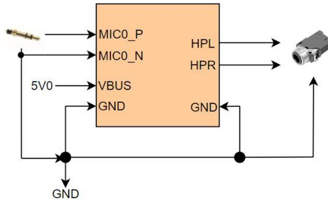
MIC0\_P 接 LINE\_IN 信号，模块 MIC0\_N 接 GND，LINE\_IN 的 GND 接模块 GND。模块降噪后会将声音通过 HPL 和 PHR 同时输出
